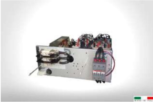
I cassetti della serie **RCL** sono progettati per i nostri armadi tipo **G9E**. All'interno di ciascun cassetto sono assemblate terne di condensatori monofase. Le versioni riportate a catalogo sono tutte dotate di induttanze di blocco, per applicazioni in presenza di un alto livello di distorsione armonica in corrente.
