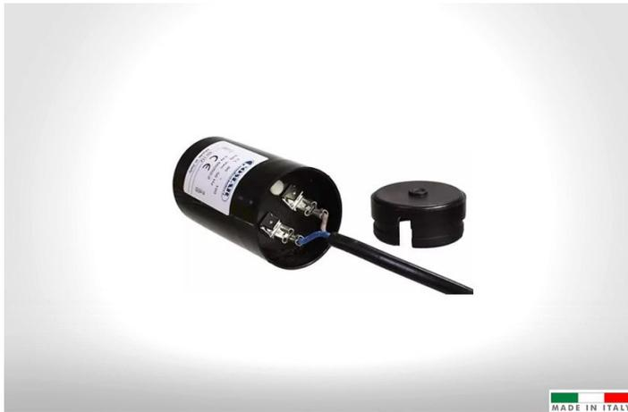
Il condensatore elettrolitico **EL** ha un'elevata capacità (valore  $\mu\text{F}$ ) in grado di fornire un'elevata coppia di avviamento al motore. È un condensatore non polarizzato appositamente progettato per applicazioni a tensione alternata intermittente per motori monofase.
